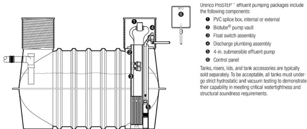
Figure 3. Effluent sewer septic tank effluent pumping package.
